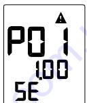
**«+»** **«-»** выбираем сервис - параметр P06 (Этот параметр позволяет выбрать «Режим регулирования»). Надпись «SE» означает, что прибор находится в сервисном режиме.
