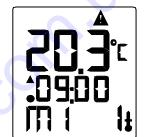
Показ автоматического режима без выбора модели регулирования, о чем свидетельствует соответствующее предупреждение на дисплее
