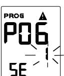
**«OK»** Его подтверждение (здесь 1- регулирование подачи с пропорционально-интегральной компенсацией внешней  $t^0$ )
