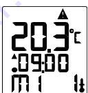
сначала, держим нажатой клавишу **«OK»** более 4 секунд, затем нажимаем **«▼»** и нажимаем **«OK»**, переходим в режим сервиса параметров
