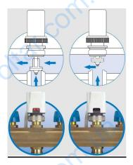
Если виден красный флажок индикатора сервопривод закрыт Если виден черный флажок индикатора сервопривод открыт
