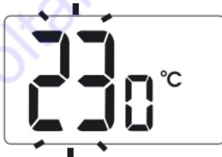
2. Кнопками **+** и **-** установить требуемую температуру с точностью до 0,2°C.
