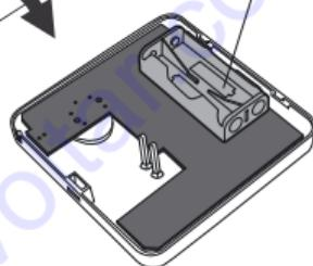
Вставить две батарейки AAA 1,5 В в батарейный отсек, соблюдая правильную полярность батареек.
