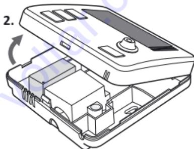
Клеммы проводов расположены на задней стенке регулятора, под пластмассовой крышкой.
