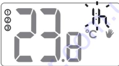
**ВНИМАНИЕ:** Ручной режим не повторяется автоматически. По истечении запрограммированного времени регулятор возвращается в режим выполнения предыдущих температурных программ: нормальный режим и временное снижение температуры, если последний был запрограммирован.
