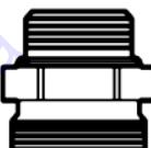
При монтаже фитингов нельзя применять клещи или тому подобный инструмент, в противном случае это приведет к деформации накидных гаек. Стальные и медные трубы должны быть чисто откалиброваны и зачищены. Мы рекомендуем применение опорных гильз. Резьбу накидной гайки необходимо смазать перед монтажом силиконовым маслом. Минеральное масло разрушает уплотнительное кольцо фитинга. Следуйте рекомендациям по монтажу, прилагаемых к фитингам.
