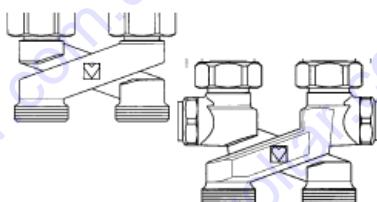
Эксцентриковый адаптер ГЕРЦ 3/4 для подключений труб различной соосности к присоединительным узлам и радиаторам с межосевым присоединительным размером 50 мм и со средним межосевым размером у подключаемых труб 35 или 40 мм.
