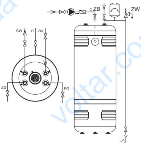
Подключение к отопительной системе следует осуществлять при помощи соединительных патрубков 1", а перед патрубками установить отсечные краны. В системах с принудительной циркуляцией (с насосом в отопительной системе), для того, чтобы теплообменник имел параметры производительности указанные в пункте „Технические данные”, следует обеспечить соответственный уровень протока теплоносителя.
