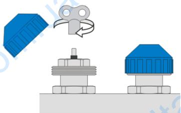
Снимите защитный колпачок и закройте клапан вращением (вправо) по часовой стрелке с помощью ключа воздухоотводчика (входит в комплект поставки).
