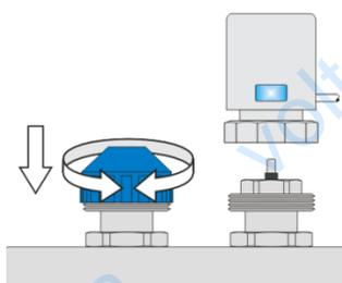
После окончания регулировки защитный колпачок или сервопривод устанавливаются на регулирующий клапан, препятствуя, таким образом, произвольной перенастройке или загрязнению клапана.
