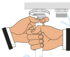
Закрутите ручную накладную гайку. Пластиковая, медная или металлопластиковая труба должна быть вставлена при этом до упора.
