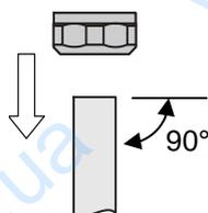
Разрежьте пластиковую, медную или металлопластиковую трубу под прямым углом, зачистите и откалибруйте ее. Наденьте накладную гайку фитинга на трубу.
