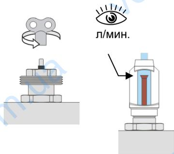
Необходимый расход теплоносителя устанавливается поворотом регулировочного шпинделя против часовой стрелки. Фактическая величина расхода теплоносителя контролируется по показаниям расходомера.
