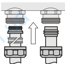
Вставьте подготовленную к монтажу трубу в выход (штуцер) коллектора.
