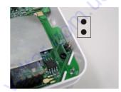
Датчик температуры помещения выключен (отсутствие якорька)
