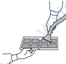
Для чистки фильтров сначала используйте пылесос, затем промойте их водой и просушите. Аккуратно установите фильтры обратно. Запрещается мыть водой угольные фильтры или фильтры «silver plasma»; для их чистки нужно использовать только пылесос.
