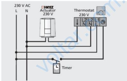
Рекомендуется использование кабелей для подключения к сети на 230В: кабель с изоляцией проводников из поливинилхлорида NYM с сечением проводников 1,5 мм<sup>2</sup> или плоским кабелем NYIF с сечением проводников 1,5 мм<sup>2</sup>.
