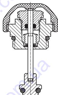
Для регулировки термостатических букс могут применяться все термоголовки ГЕРЦ с дистанционным управлением, а также компоненты электронной регулирующей системы ГЕРЦ-RTC (электронный регулятор температуры, приводы DDC) и ГЕРЦ-RTR (комнатные термостаты, термомоторы).
