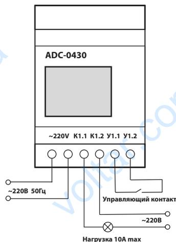
Рис.1. Схема подключения.
