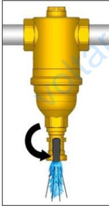
Конструкция фильтра позволяет производить обслуживание без демонтажа. После закрытия отсекающих кранов откручивается нижняя чаша фильтра и снимается сетка для очистки от примесей.
