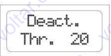
**Предельное давление:** этот параметр определяет предельное давление, чье превышение приводит к срабатыванию защиты от слишком высокого давления. Заводская настройка ВЫКЛ., указывает на выключенную защиту. Для настройки предельного давления нужно нажать на кнопки "+" и "-". Для отключения функции нажать на "+" до тех пор, пока надпись OFF не исчезнет.
