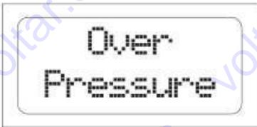
**Слишком высокое давление:** срабатывание данной тревоги указывает, что *Brio Top* обнаружил давление в установке свыше величины, отрегулированной в параметре “Plimit”. Это может случиться в системах с насосами на загрузке, то есть когда давление насоса суммируется с давлением нагрузки на входе. Если данная ошибка часто возникает, то следует попробовать увеличить параметр Plimit или обратиться к монтажнику. Для устранения состояния ошибки, нажать на центральную кнопку “reset” (сброс).
