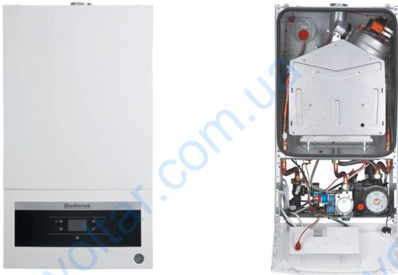
Мы позаботились о том, чтобы монтаж котла был максимально удобен и не занимал много времени. Положение пластинчатого теплообменника для ГВС сделано таким образом, что обслуживание возможно без снятия каких-либо блоков – достаточно открутить 2 накидные гайки!
