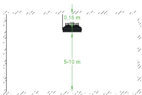
В случае высокой потребности на тепло, возможно установить больше оборудования в помещении. Чтобы обеспечить надлежащий поток воздуха, рекомендуется соблюдать рекомендуемые интервалы между тепловентиляторами, как показано на рисунке ниже.
