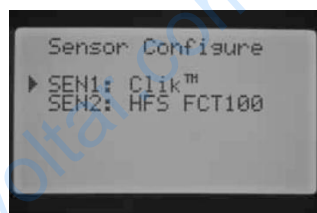
SEN 1 – метеодатчик SEN2 – датчик потока (HFS FCT100)
