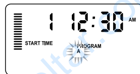
Пример мигающего экрана при удержании кнопки PRG
