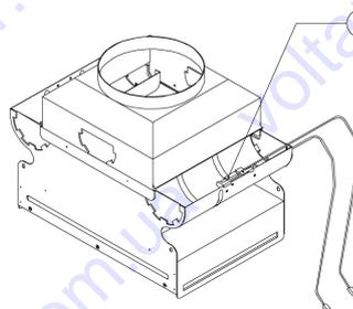
Датчик уходящих газов служит для контроля правильного дымоудаления в приборах с естественной тягой. Он располагается на коробе уходящих газов.
