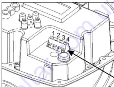
Sirio Entry снабжено специальным разъемом для вспомогательного контакта, что позволяет устройству осуществлять дополнительные функции, когда к нему подсоединяют внешнее оборудование. Функции вспомогательного контакта зависят от настроек параметров «Вспомогательного Контакта», которые описаны в разделе «Программирование». Три рабочих режима, соответствующие функции и способы подсоединения описаны ниже.
