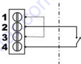
**⚠ ВНИМАНИЕ!** Неправильное проводное соединение вспомогательного контакта может привести к потере напряжения, короткому замыканию, и, в последующем, к сгоранию предохранителей! Соединения должны производиться с особой тщательностью.
