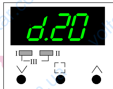
Рисунок 8 – Встановлення гістерезису температур (напр., 20°C)
