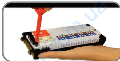
**3** Закрепите KL04NSB на стене или DIN-рейке. Если крепите KL04NSB в близости KL08NSB - используйте короткий соединительный шлейф, в противном случае, используйте 2й более длинный шлейф.
