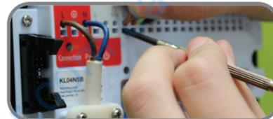
**10** Провода сервоприводов поместите в соответствующее места платы. Один регулятор может управлять до 4 сервоприводов.
