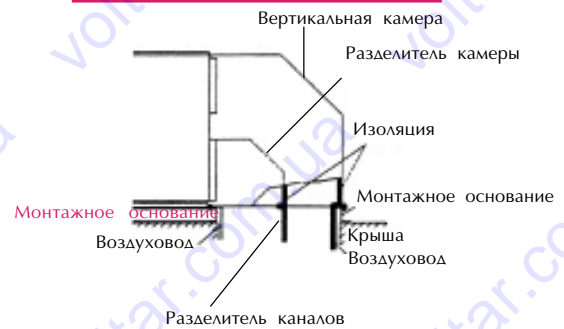
Монтаж воздуховодов с использованием камеры для моделей с горизонтальной раздачей воздуха
