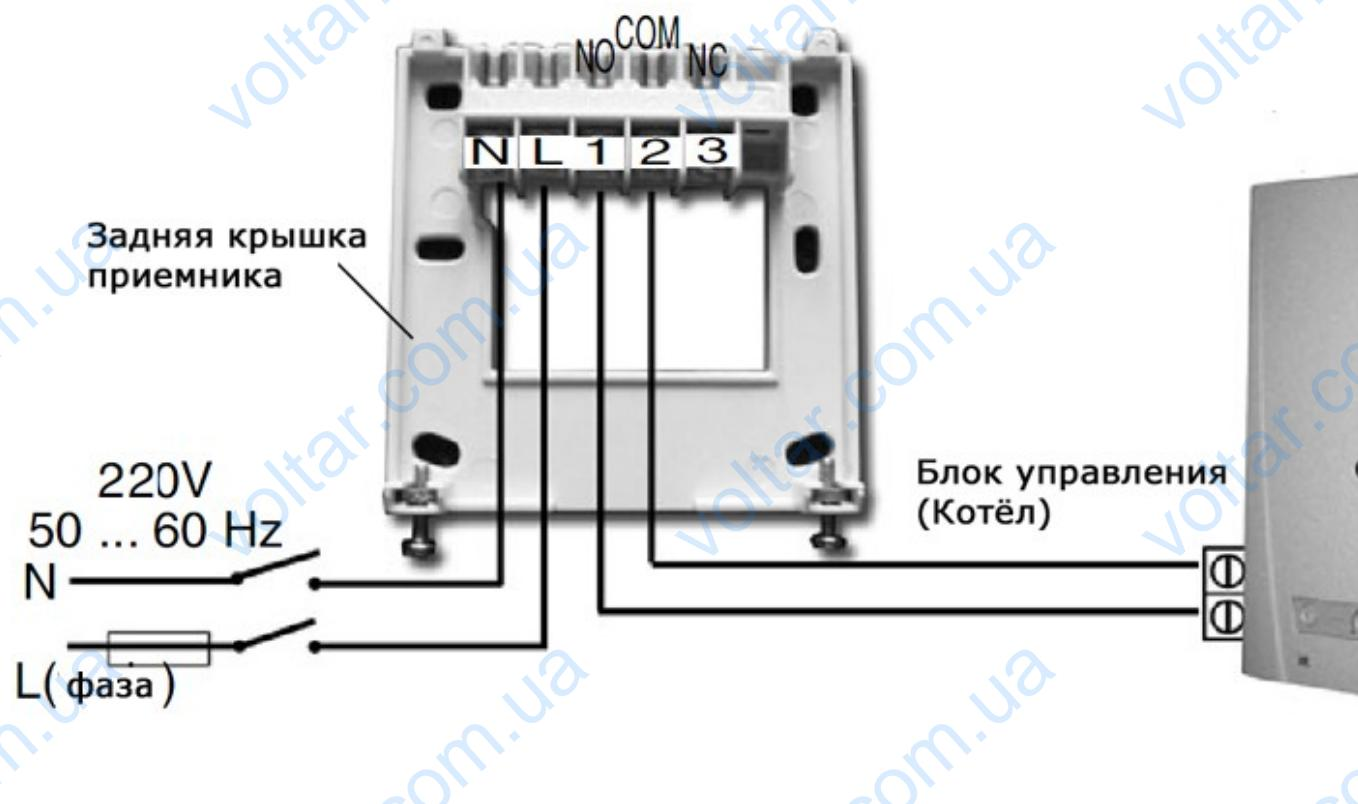
Приёмник подключается к сети напряжением 220В, 50Гц. Ноль подключается к точке N, а фаза к точке L. Советуем делать монтаж через вилку, чтобы можно было выключить приёмник при необходимости. Приёмник руководит работой котла при помощи реле с точками подключения 1 (NO), 2 (COM), 3 (NC). Для управления обогревающим прибором - котлом приёмник подключается к точкам 1 (NO) и 2 (COM), а для управления охлаждением - кондиционером приёмник подключается к точкам 2 (COM) и 3 (NC).
