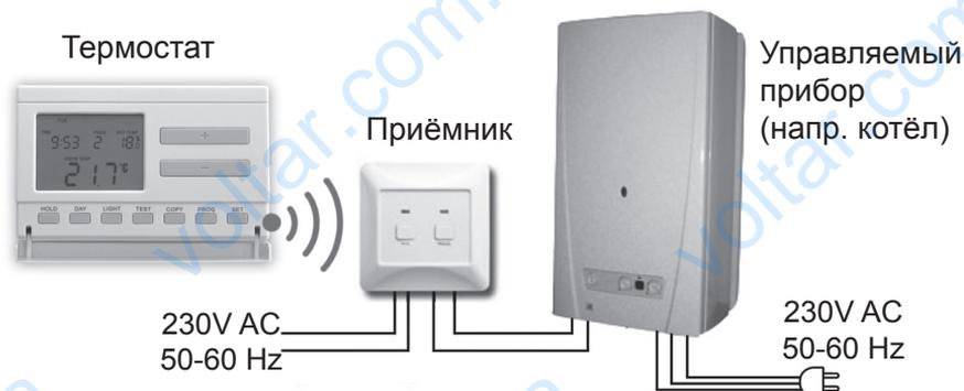
Термостат состоит из двух частей - свободно переносимого комнатного термостата и принимающего устройства, которое осуществляет управление котлом /кондиционером. Между двумя устройствами существует радиочастотная связь. На заводе оба устройства настроены на одну частоту для совместной коммуникации.
