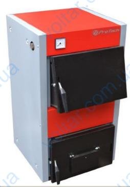
Стальной, сварной, твердотопливный котел чугунными колосниками, изготовлен из высококачественной котловой стали 3 мм. с увеличенной площадью теплообмена.
