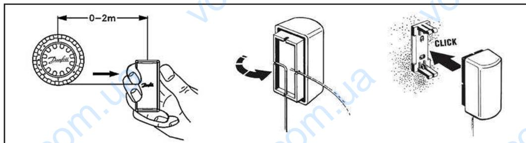
Під час монтажу термостатичного елемента з виносним датчиком необхідно враховувати, що датчик не повинен бути закритий (наприклад, шторою) та зазнавати впливу протягів. Не можна також встановлювати його над джерелом високої температури.
