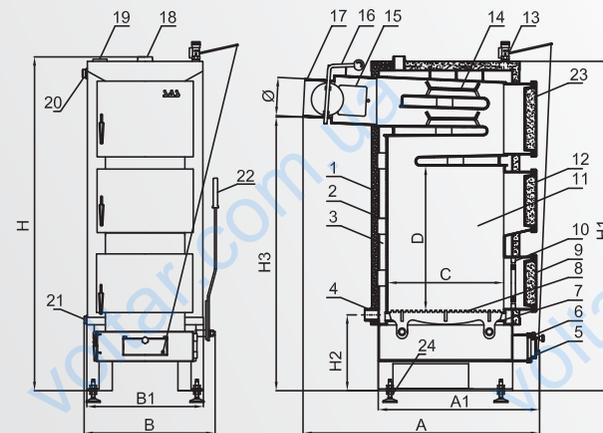
1. Корпус котла; 2. Теплоизоляция; 3. Теплообменник; 4. Патрубок обратки; 5. Дверца дозирующая воздух; 6. Дверца зольника; 7. Колосники; 8. Подвижная колосниковая решетка; 9. Дверца камеры сгорания; 10. Противопожарная решетка; 11. Камера сгорания; 12. Дверца засыпная; 13. Регулятор тяги; 14. Завихрители; 15. Отверстие для чистки дымохода; 16. Дроссельный клапан; 17. Дымоход; 18. Патрубок горячей воды; 19. Термометр; 20. Ручка чистки колосников; 21. Спускной патрубок; 22. Дверца для чистки.
