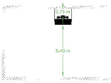
В случае высокой потребности на тепло, возможно установить больше оборудования в помещении. Чтобы обеспечить надлежащий поток воздуха, рекомендуется соблюдать рекомендуемые интервалы между тепловентиляторами, как показано на рисунке ниже.
