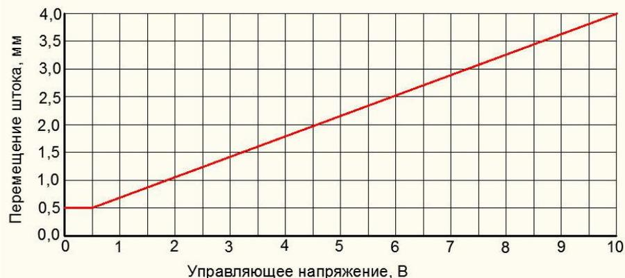
При напряжении управляющего сигнала менее 0,5 В клапан удерживается в закрытом положении усилием пружины, что исключает влияние электрических наводок на работу привода при длинном низковольтном кабеле.
