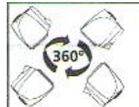
5.1. Привод может устанавливаться в любом монтажном положении.
