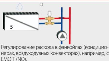
Регулирование расхода в фэнкойлах (кондиционерах, воздушных конвекторах), например, с EMO T (NO).
