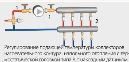
Регулирование подающей температуры коллекторов нагревательного контура напольного отопления с термостатической головкой типа К с накладным датчиком.
