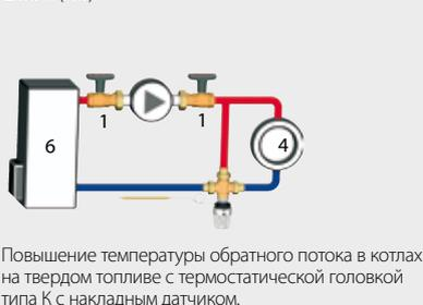
Повышение температуры обратного потока в котлах на твердом топливе с термостатической головкой типа К с накладным датчиком.
