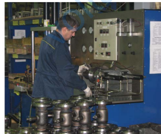
Тестирование шаровых кранов
