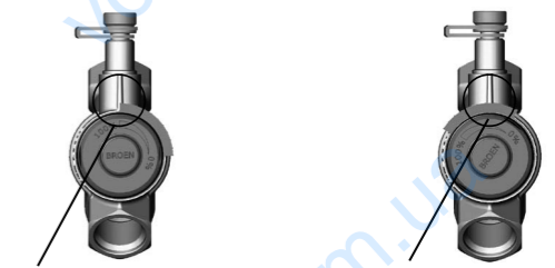
Рис. 39. Грубая настройка клапана БРОЕН Dynamic на расчетный расход (без расходомера)
