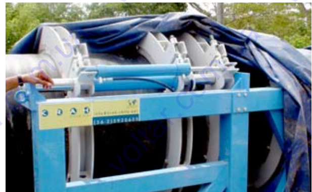
Стикове зварювання труби Krah
