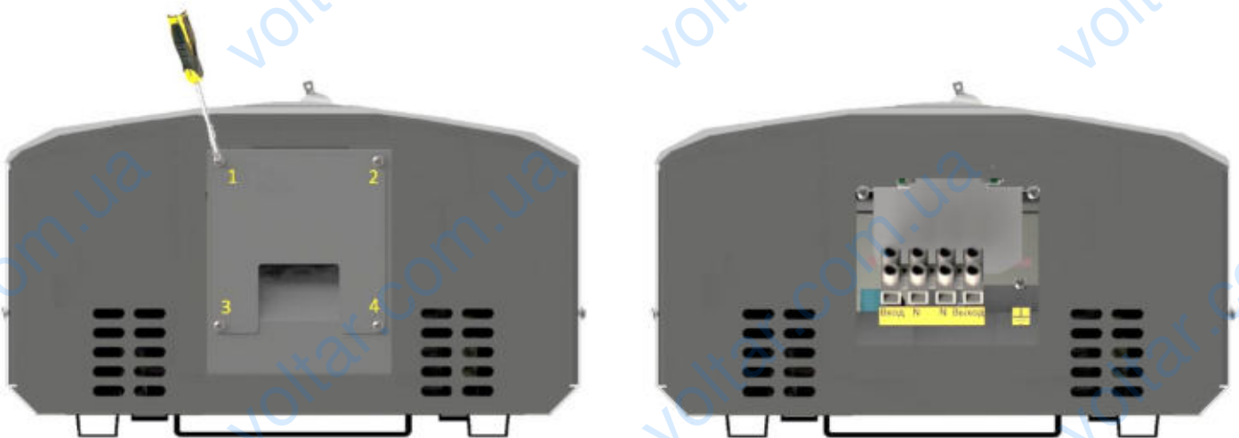
Рисунок 13. Схема зняття захисної кришки знизу корпусу стабілізатора
