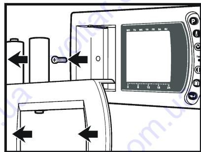
**3.** Вывернуть нажимной винт и снять предохранительную крышку .
