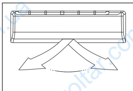
На долгое время не направляйте воздушный поток (кнопкой SWING с пульта ДУ) вниз во время работы кондиционера в режиме охлаждения и осушения. Иначе, при определённых условиях температуры и влажности, на поверхности пластин жалюзи вертикального направления воздушного потока может возникнуть конденсация и как ее следствие – вода.
