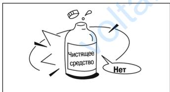
Не пользуйтесь для чистки кондиционера щелочными чистящими средствами. Под воздействием этих средства детали кондиционера (лоток для слива конденсата, теплообменник и т. д.) быстро разрушаются!
