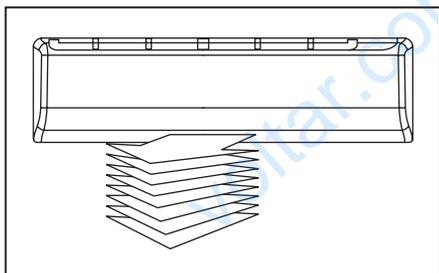
Регулируйте жалюзи горизонтального направления воздушного потока только при выключенных “автоколебаниях” (SWING), если Вы не уверены в своих действиях - выключите кондиционер, и, аккуратно повернув руками первую лопасть на удобный угол, без каких-либо усилий, установите требуемый угол для вертикальных жалюзи!
