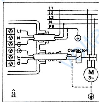
Для трехфазных двигателей с подсоединением к магнитному пускателю
