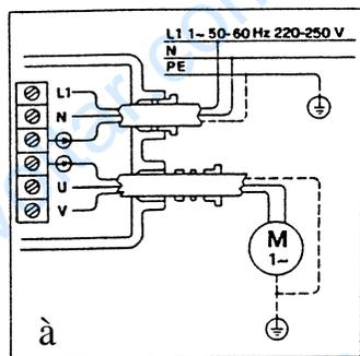
Для однофазных двигателей мощностью до 1,1 кВт; 220 В; 50Гц
