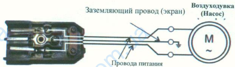
Рис. Подсоединение проводов от воздуходувки/насоса к вилке
