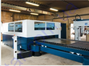
Разделение листового металла при помощи лазера
