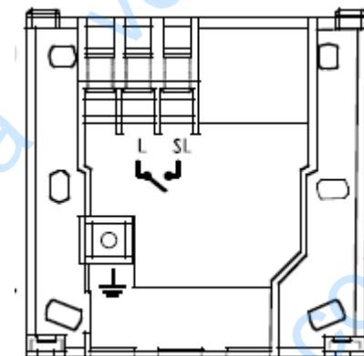
7) Этот прибор имеет двойную изоляцию, поэтому заземлить его надо только в клемме заземления, предусмотренной для этой цели.
