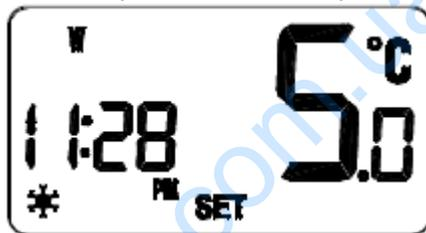
При работе в режиме ручного ввода значений, на ЖК экране будет отображаться временное значение заданной температуры.
