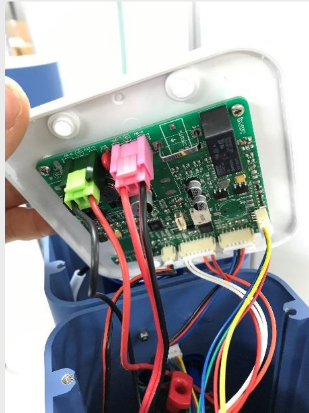
Рис.2: обережно від'єднайте проводку від плати
