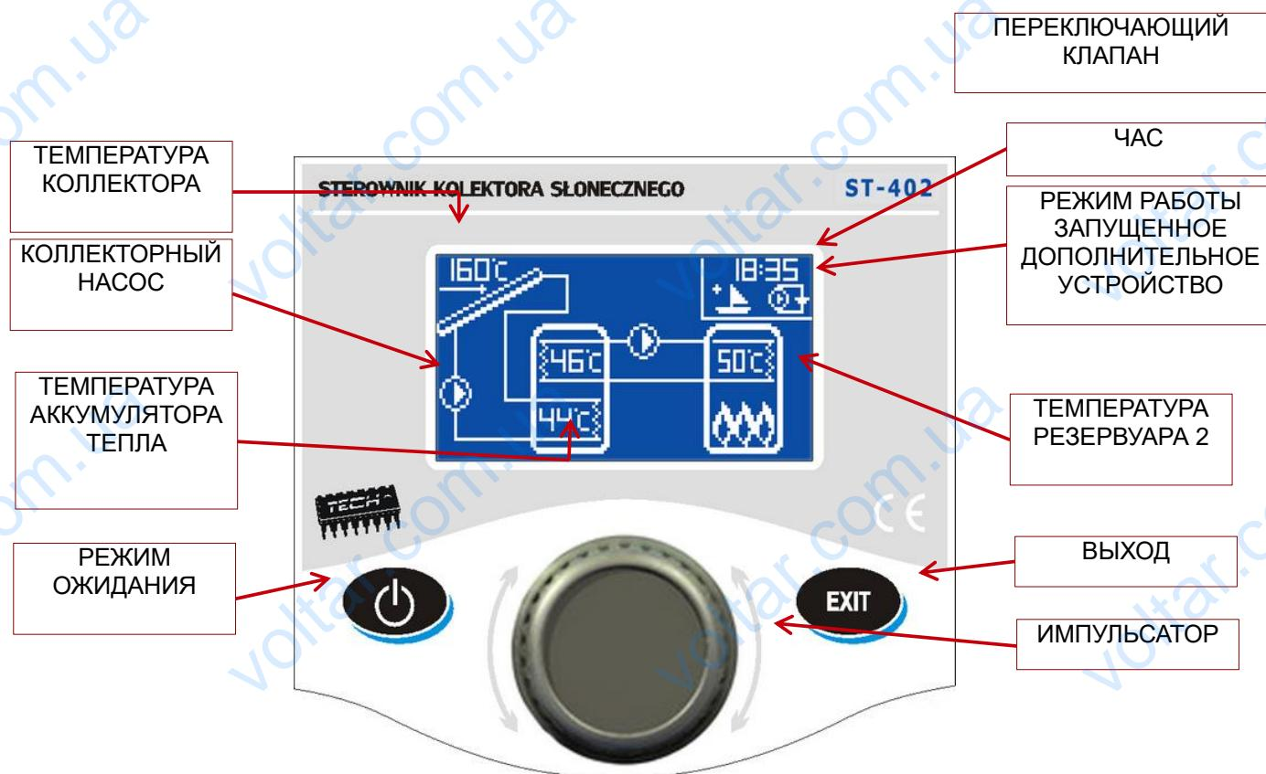
Обслуживание регулятора осуществляется с помощью импульсатора. Вход в меню и подтверждение настроек выполняется нажатием круглой кнопки импульсатора. Перемещение по функциям
