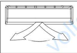
Акуратно поверніть основну пластину жалюзі при вимкненому кондиціонері вниз, щоб побачити вертикальні напрямляючі (жалюзі), що виконані з прозорої пластмаси.
