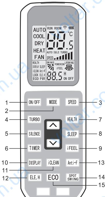
**10 Кнопка «DISPLAY»** вмикає/вимикає індикацію на панелі внутрішнього блоку. Зручно на ніч вимкнути індикацію, щоб світло від неї не заваджало сну.
