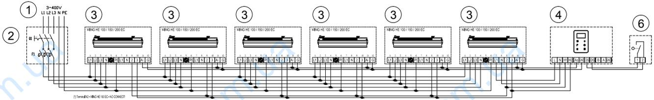
(\*) Терминал N2 - WING E100-EC - НЕТ СОЕДИНЕНИЯ / (\*) - Терминал N2 - WING E 100-ec - НЕМАЄ ПІДКЛЮЧЕННЯ!
